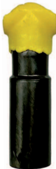
Tube à moitié supermoulé
