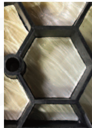
Supermoulage® de fibres de lin Source : Protoform 2020
