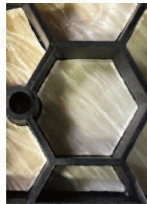
Supermoulage® de fibres de lin Source : Protoform 2020
