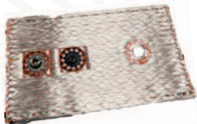
Pour réduire le nombre d'opérations d'assemblage et améliorer leur intégration dans la pièce finale, les inserts peuvent être mis en œuvre dès le placement des fibres, à l'étape du **HV-TFP** ou pendant le **Supermoulage**®.
